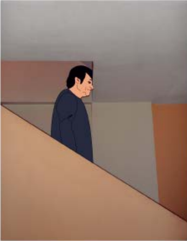
Cabezada de escalera de 1,65 m
