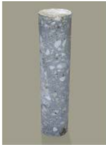
Testigo de muro
