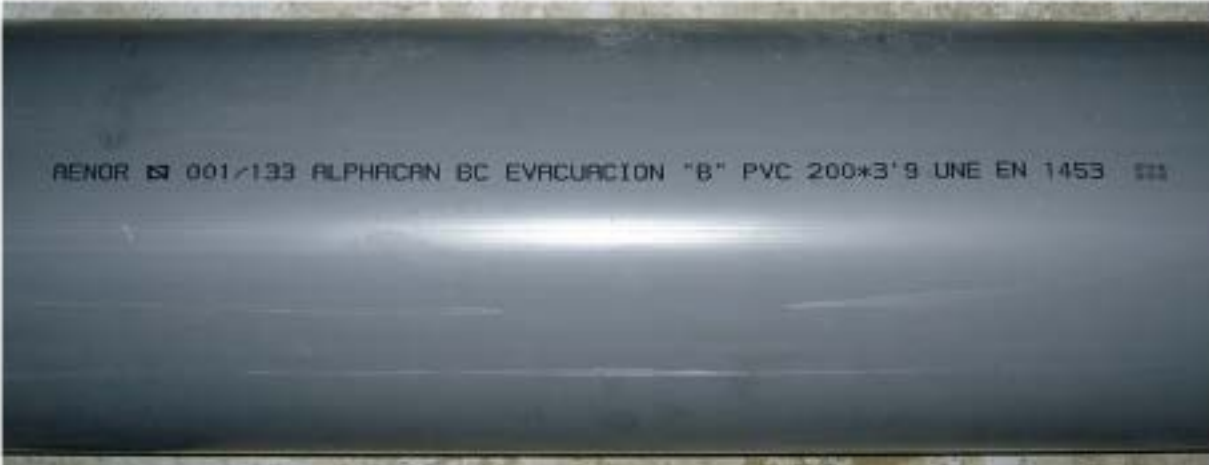
Identificación colector de PVC
