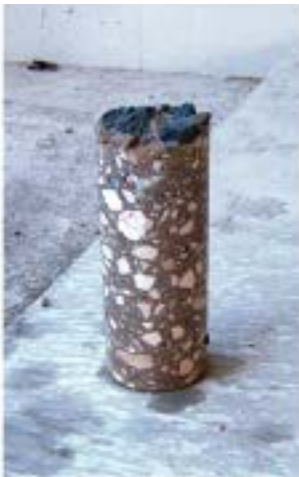
Testigo de cemento
