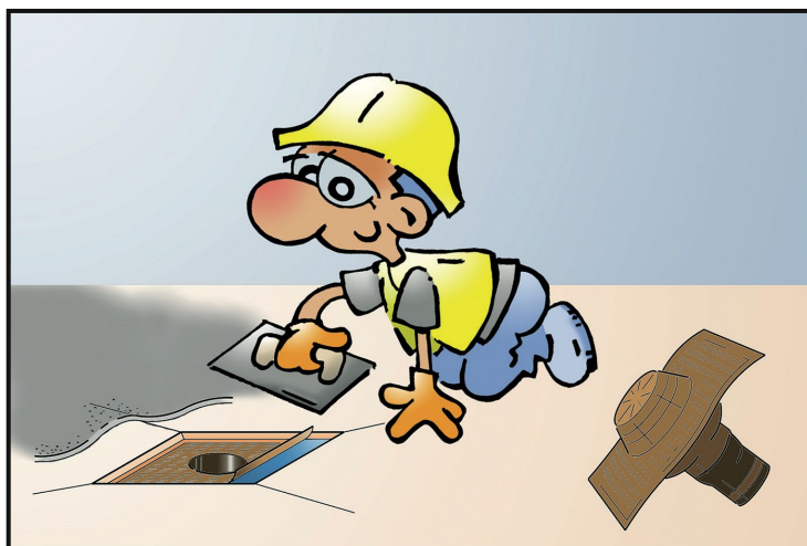
-Dibujo 3- Realización de rebaje en el tendido de regularización en el encuentro con la cazoleta.
