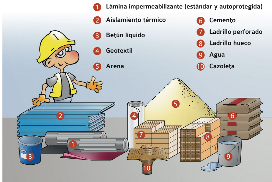
-Dibujo 1- Materiales para la realización de una cubierta plana invertida no transitable bituminosa.
